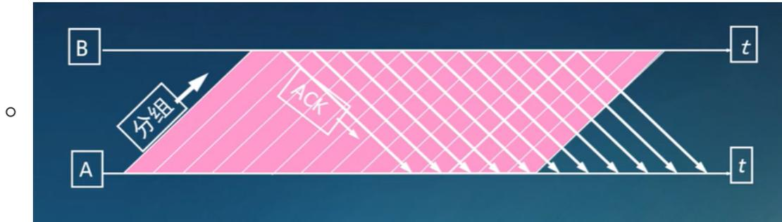
1. 采用流水线传输思想，即发送方可以连续发送多个分组，不必每发完一个分组就停下来等待对方的确认
