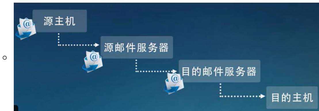
Server 在 25 号端口上监听，有连接请求时，接受连接，然后传输邮件，传输完毕后再将连接断开。
