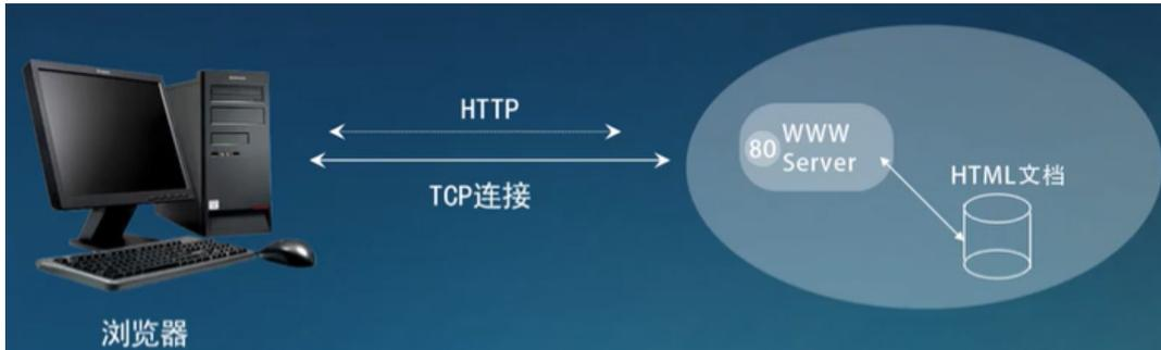
1. WWW的工作模型中，首先要有一个WWW的服务器，它是等待用户的连接请求的。用户想要访问一个WWW服务器，那么就要连接它的80端口与他建立TCP连接，然后将自己要访问的WWW文档的地址发给这个服务器，这个服务器再到自己的WWW文档库中找到相应的文档返回给客户端，在这个过程中就要解决刚才的3个问题。
